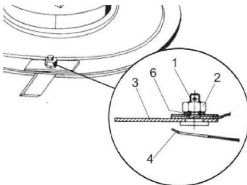
Nikdy nespustite stroj s neúplným počtom nožov alebo s nerovnomerne nabrusenými nožmi. Môže dôjsť k poškodeniu v dôsledku zvýšených vibrácií.
